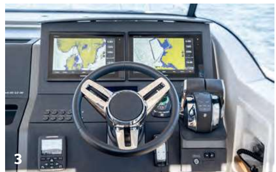
1 Die großzügige Lounge ist der soziale Mittelpunkt der Yacht. Beachte die Wetbar hinter dem Fahrstand. 2+3 Aufgeräumter Fahrstand mit verstellbarem Lenkrad, Joystick, Vollausrüstung und Platz für drei Crewmitglieder.
