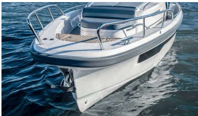
Die runde Bugnase ermöglicht das problemlose Anlanden. Typisch Schweden-Qualität: Die umlaufende stabile Scheuerleiste, die gut dimensionierten Festmacherbeschläge und das solide Ankergeschirr.
