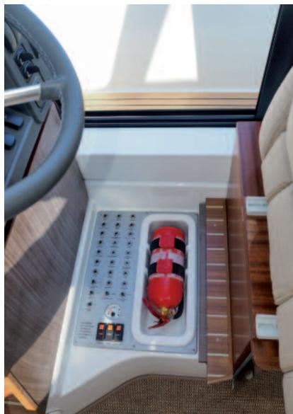
Gut zugänglich und übersichtlich: Die E-Installation unter dem Fahrerfußraum. Ein Feuchtigkeitsschutz sollte nachgerüstet werden.
